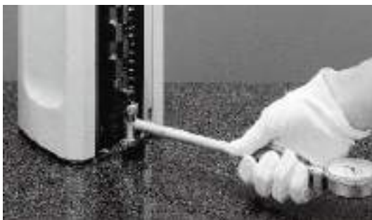
高度規搭配塊規歸零
