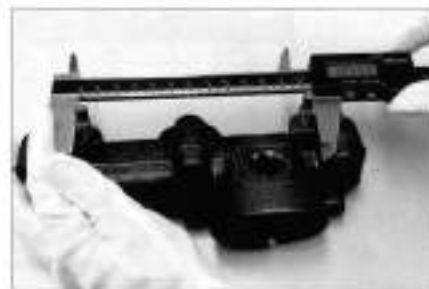
使用卡尺測定螺絲孔間距
